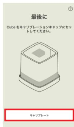
4-10. キャリブレーションプレート（測定の基準値の調整）が開始されます。
