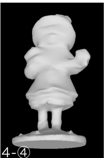
**1** 生成された 3D モデルをビュー操作ツールで確認してみると、3D モデルの台座下部が盛り上がっていることに気づくと思います。
